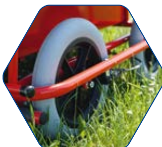
Spezielle Leichtlaufräder mit Schaumfüllung
